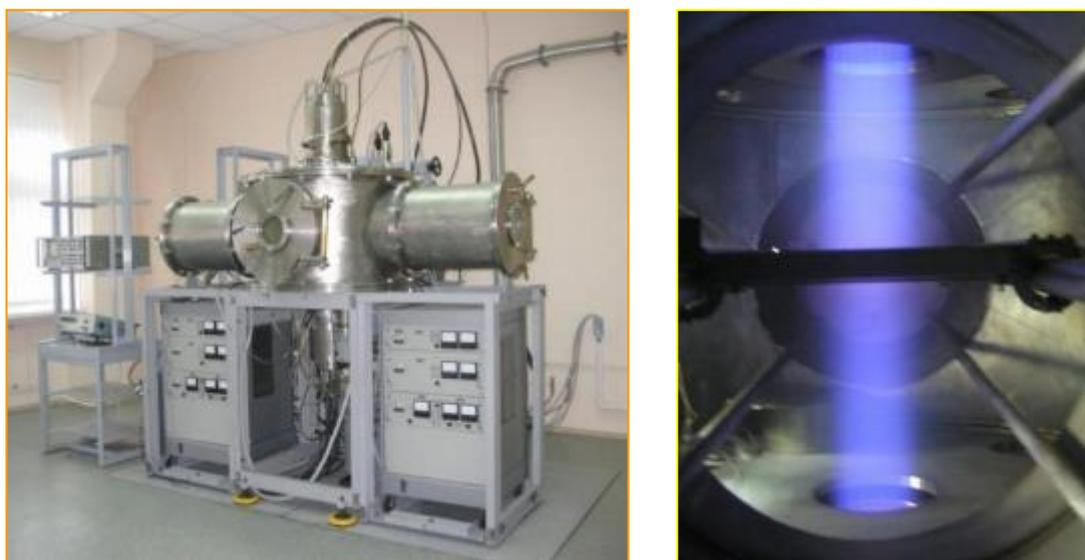
Рисунок 4 - Ионный имплантер ИЛИМ-1
