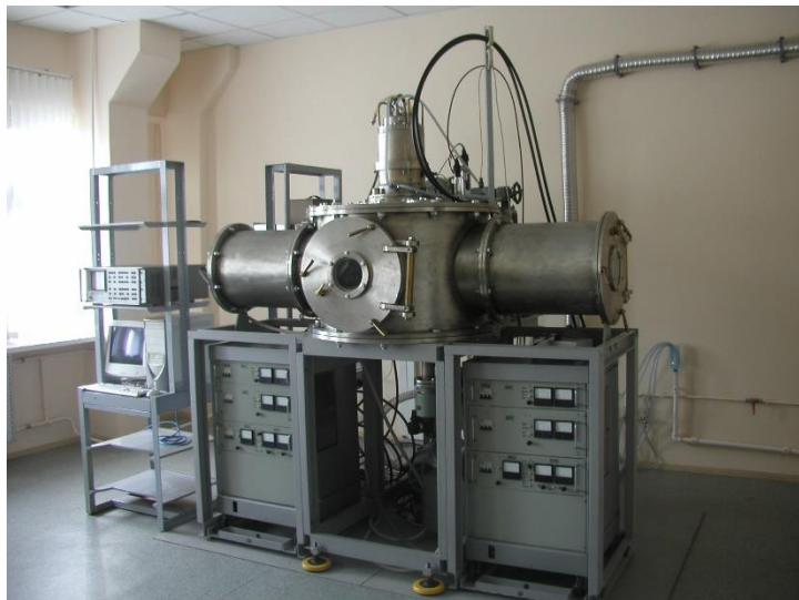
Ионный имплантер ИЛМ-1 с ионным источником ПУЛЬСАР-1М S = 100 \text{ см}^2 j = 50 - 500 \text{ мкА/см}^2 E = 5 - 50 \text{ кэВ}
