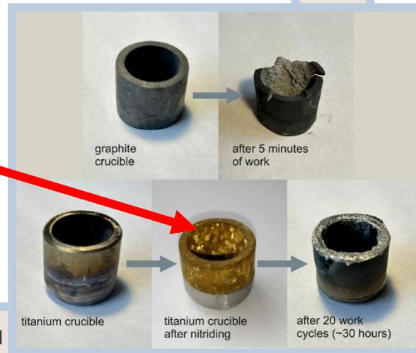
Рисунок 2. Фото графитового и титанового тиглей
