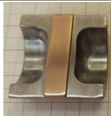
Расположение образца в половине КМП и распределение токов в такой системе
