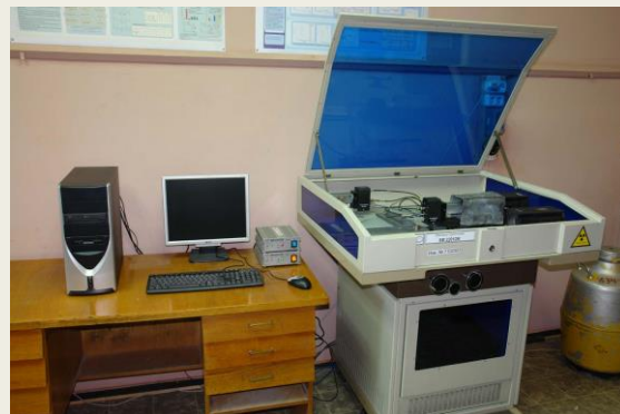
Автоматический мессбауэровский спектрометр SM-2201 в режиме постоянного ускорения. Источник \gamma -квантов — ^{57}\text{Co} в Rh
