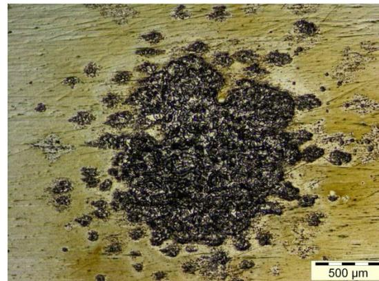
Снимки разрядных пятен от четырех разрядов на Fe электроде. Оптический микроскоп Olympus.
