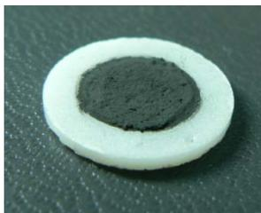
Внешний вид образца с нанесенными электродами
