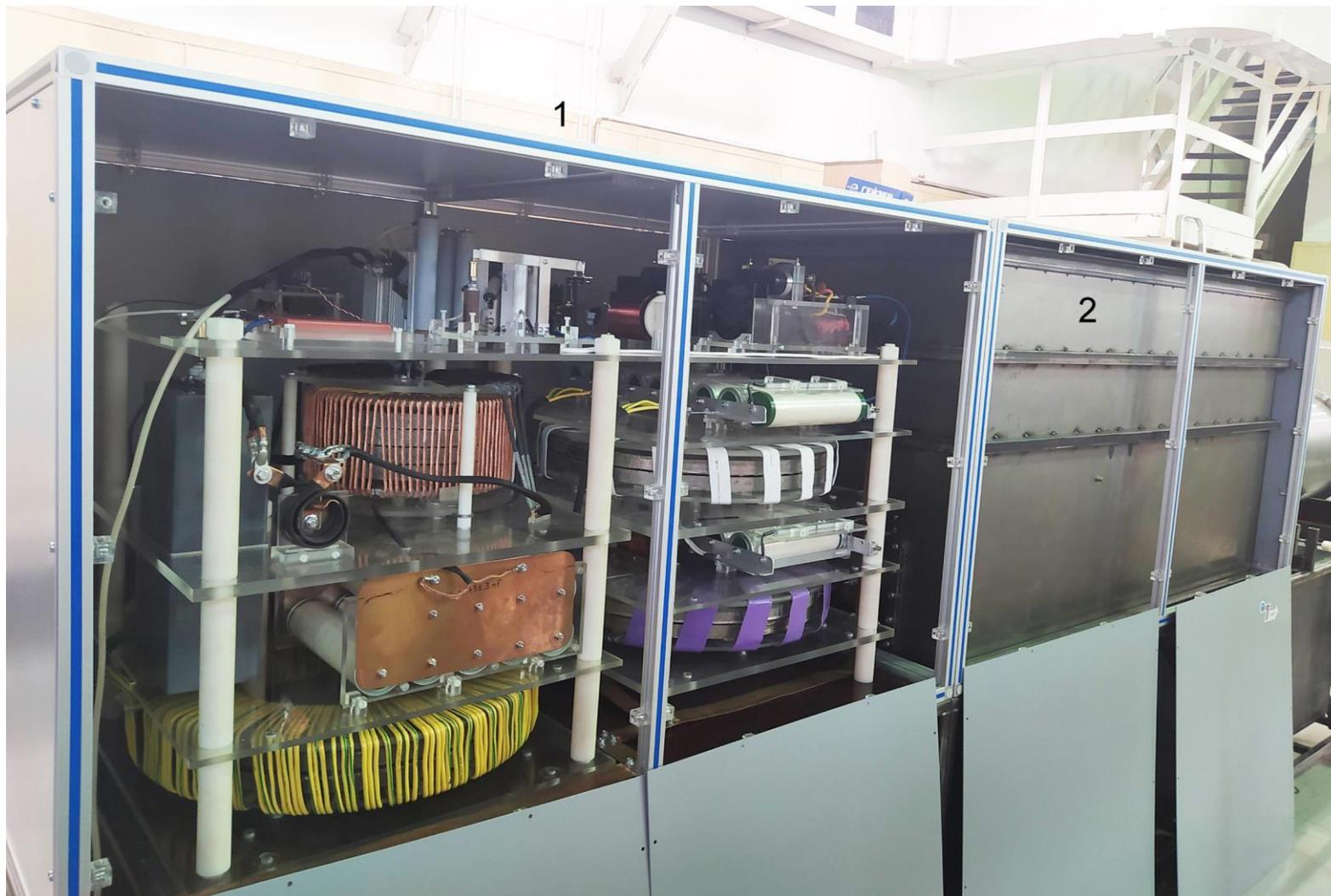
Вид на генератор сбоку со снятыми панелями: 1 – воздушная часть корпуса; 2 – отсек с высоковольтным масляным баком
