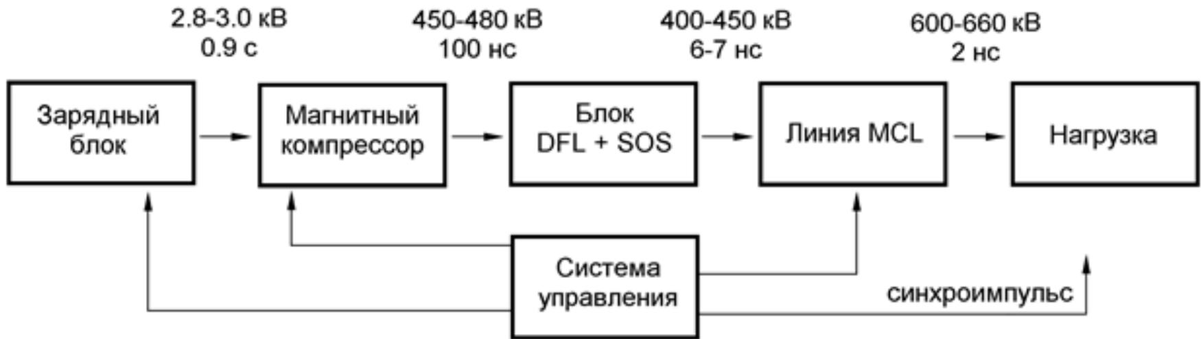
*Система управления* - выдает импульс для синхронизации работы генератора с внешней нагрузкой.
