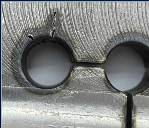
Трещина на поверхности индуктора
