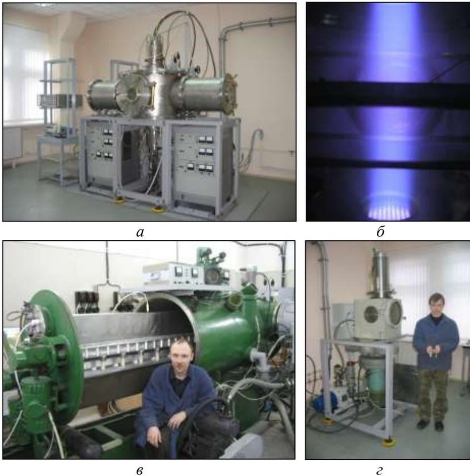
Рис. 8. Оборудование для радиационной обработки материалов ионными пучками: (а) ионный имплантер для двухсторонней обработки движущихся полос сплавов встречными пучками ионов [47], (б) встречные пучки ионов (снимок через окно камеры), (в) действующий макет ленточного источника ускоренных ионов, сечением  $20 \times 1200 \text{ мм}^2$ , для обработки листового проката [48], (г) установка для радиационной обработки расплавов
