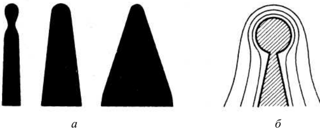
Рис. 8.1. a – Типичные профили автоэлектронного эмиттера, полученные в электронном микроскопе, б – Проводящая сфера на ортогональном конусе и соответствующие эквипотенциальные поверхности (тонкие линии).
