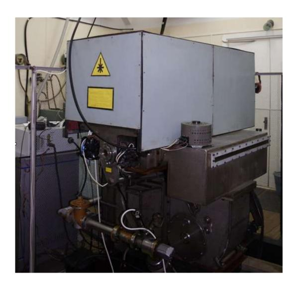
Рис.1. Фото СО<sub>2</sub>-лазера "ЛАЭРТ"
