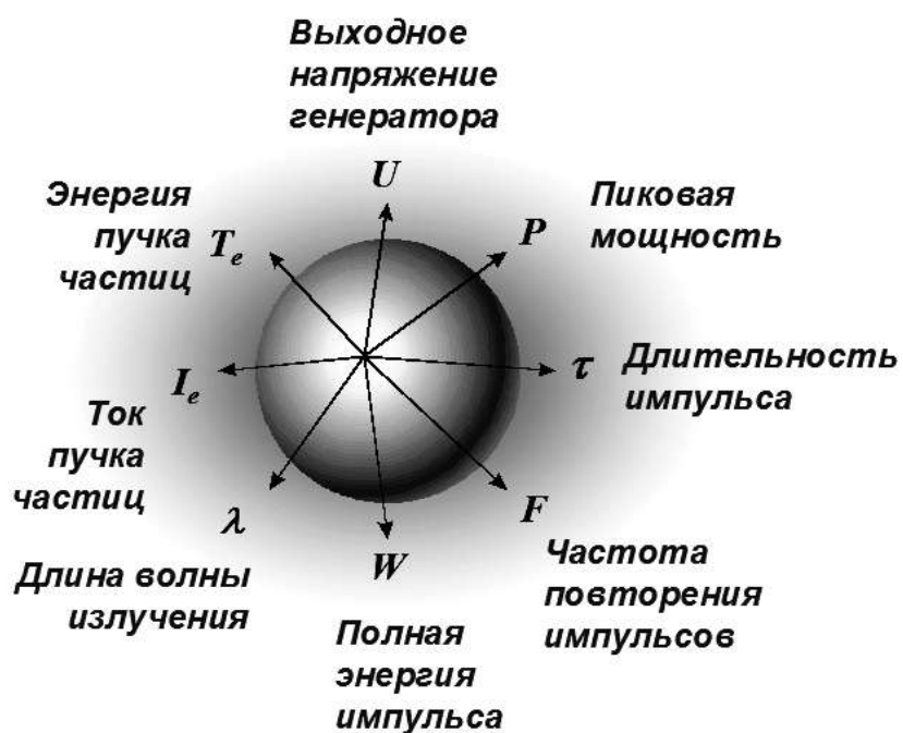
Рис.1.1. Параметры, характеризующие импульсную систему, включающую различные варианты нагрузок в виде источников пучков частиц и электромагнитного излучения.
